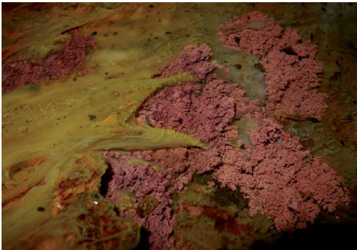
Obrázek 1: Nárůst bakterií oxidujících železo v kyselé důlní vodě ( Ferroplasma acidiphilum , Acidithiobacillus ferrivorans ) a keřík cementační mědi, která se z této vody sráží v přítomnosti železa.
